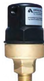
Oberteil aus Nylon oder PP Sockel aus VA oder Messing Dichtungen aus EPDM/BUNA-N
