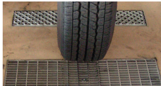
Abdeckung Belastungstest SECURIN®: nach 3 085 020 Überfahrten unbeschädigt!
